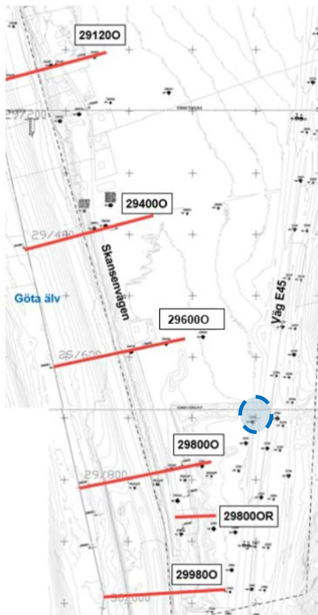
Figur 5. Plan, beräkningssektioner, WSP PM 2023-10-20 Norra Skansenvägen (SGI d.nr. 6.2-2206-0639). Skadeplatsen har markerats med blåstreckad linje.
