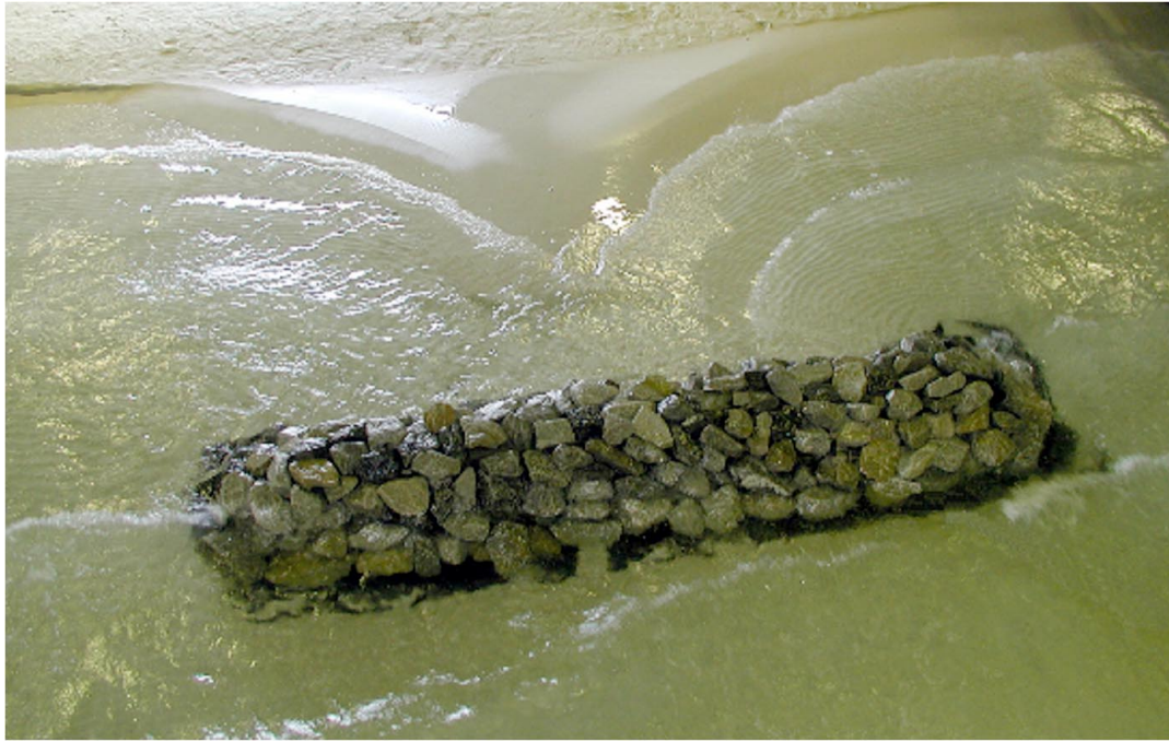
Figur 13 Åskådliggörande genom modellförsök i laboratorium av den friliggande vågbrytarens funktion genom att den förändrar vågriktningen respektive minskar våghöjden (Foto: Hans Hanson).
