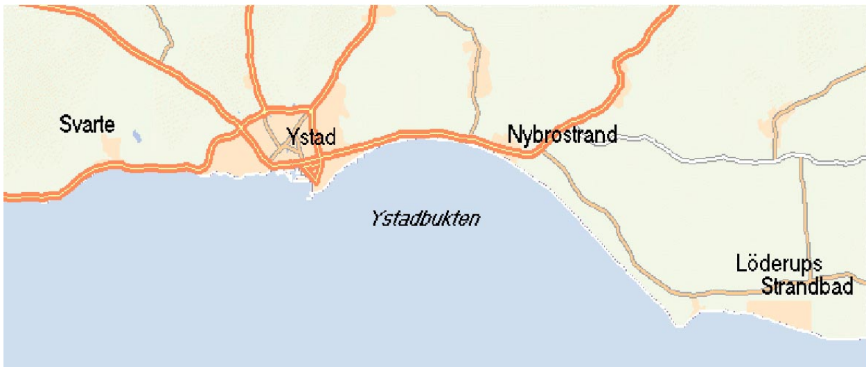
Figur 18 Kustens utseende i Ystadbukten med en kuststräcka i balans ur erosionssynpunkt från Nybrostrand och ut till den yttersta udden (Kåseberga), samt med en kuststräcka under intensiv erosion vid Löderups strandbad (Grafik: Hans Hanson).
