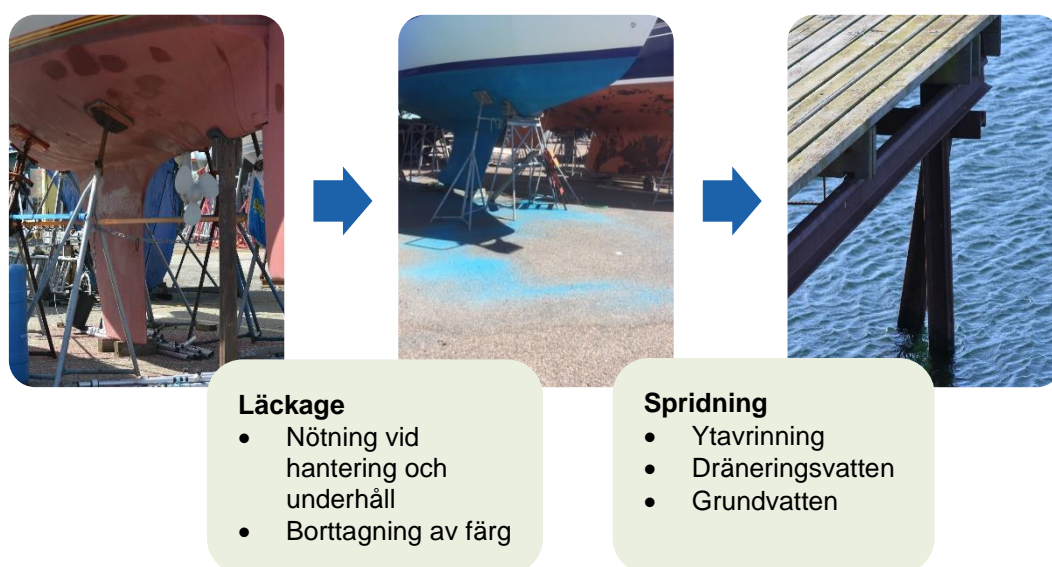
Figur 6-2 Schematisk bild av föroreningsspridning vid båtuppställningsplatser. Föroreningen tillförs området via båtarna, från vilka spridning sker till mark. För att förhindra detta kan ämnena tas bort från skroven eller läckagevägen brytas. Förorening i mark kan via vatten spridas vidare till sediment och ytvatten, där effekterna kan bli stora. För att förhindra detta kan den förorenade marken åtgärdas eller spridningen begränsas.
