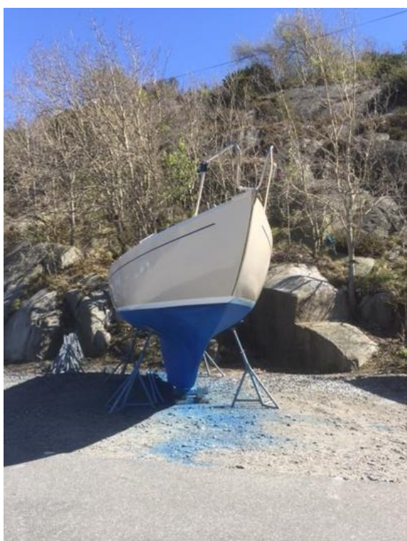
Figur 6-1 Spridning av färg vid underhåll av båtbottn. Foto: Helena Martinell, Göteborgs miljöförvaltning.
