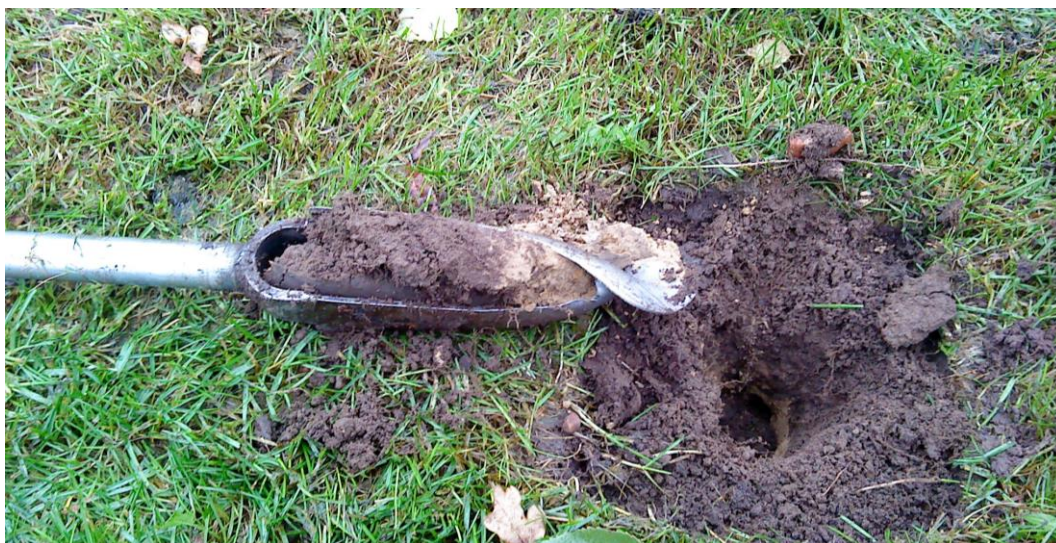
Figur 4-1 Provtagning med manuell skruv, Auger. Foto: SGI.
